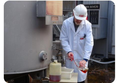
ABB Sécheron AG 的 Eric Killer (左图正在取样，上图在实验室中) 使用 BAUR 设备测量绝缘油的击穿强度，提供得出绝缘油状态结论的实验室值。
