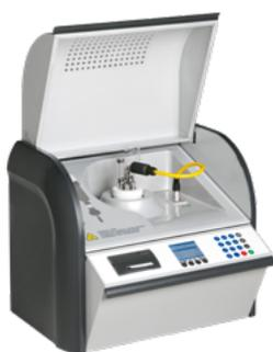
BAUR DTL C 绝缘油介损测试仪可为电力和工业工厂中的高效油管理提供精确的信息。设备可全自动测量损耗因数、电阻率以及绝缘油的介电常数。设备出厂时即已附带八种符合标准的测量流程 ( 同样符合 IEC 61620 标准 )，确保能够快速获得全面的分析结果。
