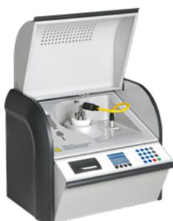
Das Ölprüfgerät BAUR DTL C bietet präzise Informationen für ein effizientes Ölmanagement in Anlagen der Elektrizitätswirtschaft und Industrie. Es misst vollautomatisch den Verlustfaktor, den spezifischen Widerstand und die Dielektrizitätszahl von Isolierölen. Im Gerät sind ab Werk acht verschiedene, den Normen entsprechende Messabläufe hinterlegt (auch nach IEC 61620), um schnell zu umfassenden Analyseergebnissen zu kommen.
