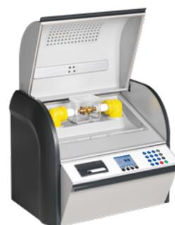
Das Ölprüfgerät BAUR DTA 100 C ist für das vollautomatische Messen der Durchschlagsspannung an flüssigen Isolierstoffen bis 100 kV im Labor-Dauereinsatz konzipiert. Als Hochleistungsgerät bietet es eine eindeutige Durchschlagserkennung und verlässliche, reproduzierbare Messergebnisse auch über mehrere Messabläufe hinweg.
