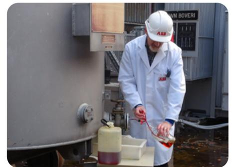
Eric Killer von ABB Sécheron AG ermittelt mit BAUR Geräten die Durchschlagfestigkeit des Isolieröls sowie Laborwerte, die Rückschlüsse auf den Ölzustand liefern.
