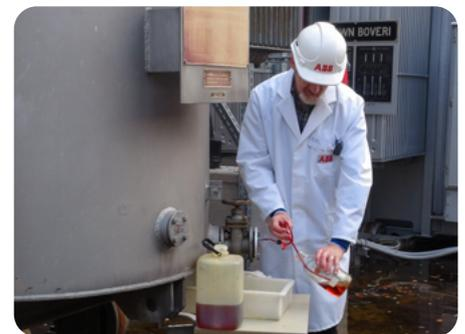
Utilizando equipos de BAUR, Eric Killer de ABB Sécheron AG determina la rigidez dieléctrica del aceite aislante y obtiene valores de laboratorio que permiten conocer el estado del aceite.
