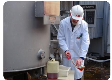
Eric Killer d'ABB Sécheron SA détermine au moyen d'équipements BAUR la rigidité diélectrique de l'huile diélectrique ainsi que les valeurs de laboratoire qui permettent d'évaluer l'état de l'huile.
