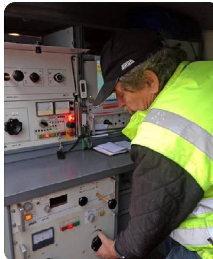
Willi Bohler – hier im Kabelmesswagen - ist Messtechniker bei der Gasenzer AG (exklusiver Handelspartner für BAUR Geräte in der Schweiz und hier zuständig für die Kabelfehlerortung).
