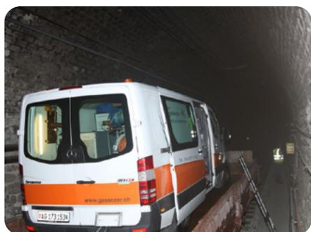
Il laboratorio mobile di ricerca guasti sui cavi BAUR viene trasportato nel traforo del Sempione con la speciale locomotiva di servizio dell'assistenza di FFS.
