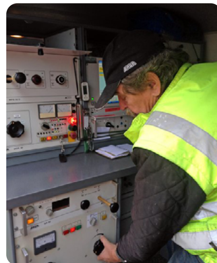
Willi Bohler – ici dans le laboratoire mobile de maintenance des réseaux – est technicien de mesure à la Gasenzer AG (partenaire commercial exclusif pour les appareils BAUR en Suisse et responsable ici de la localisation des défauts de câble).
