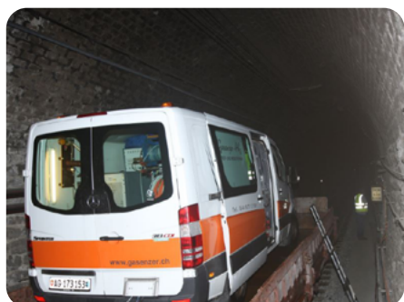
O veículo para teste de cabos da BAUR é transportado para o túnel Simplon pelo vagão especial do serviço de construção da SBB.
