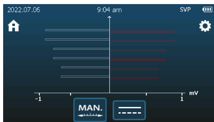
Lokalizacja uszkodzeń powłoki z użyciem sekwencyjnego napięcia stałego
