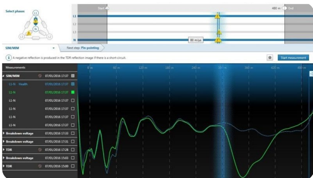
BAUR 软件 4 的显示器可以一目了然地显示出所有重要的设置、电缆故障定位参数以及电缆数据。屏幕的下方显示测量结果，并可以立即记录重要的结果。
