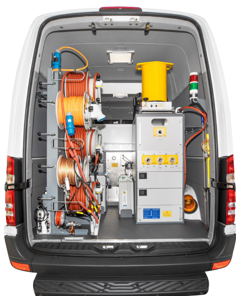
Primer PD-TaD u kombiju za kablovsko testiranje
