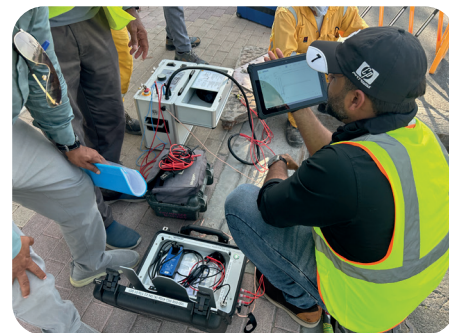
Exakte Fehlerlokalisierung dank Step TDR
