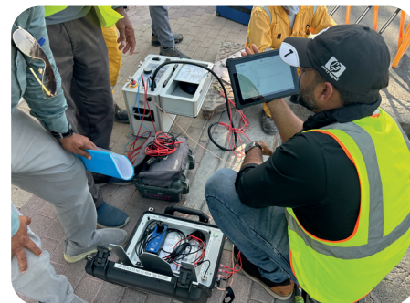
Localización exacta de averías gracias a Step TDR
