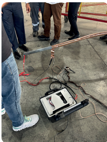
Step TDR es idóneo para el extremo del cable
