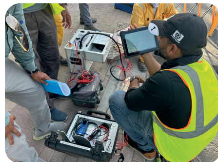
Localização exata de falha graças ao Step TDR
