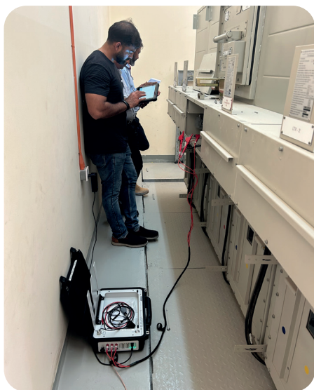
Medições com o reflectômetro de pulso IRG 400 portátil da BAUR
