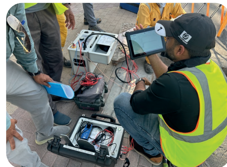
Точное обнаружение мест повреждения благодаря технологии шаговой рефлектометрии
