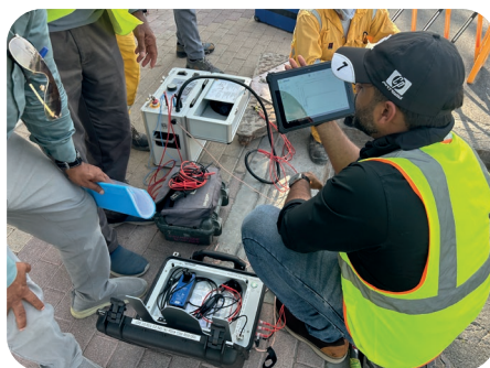
凭借"阶跃"TDR，实现电缆故障精准定位
