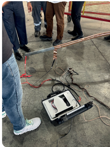
"阶跃"TDR 完美适配电缆末端
