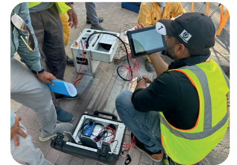
凭借"阶跃"TDR，实现电缆故障精准定位
