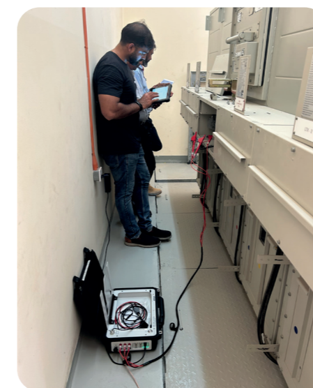
Mediciones con el reflectómetro de impulsos IRG 400 portable de BAUR
