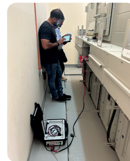
Mesures avec l'échomètre IRG 400 portable BAUR
