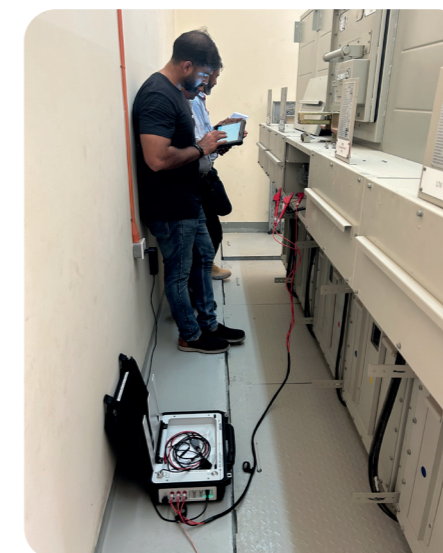
Misure con l'ecometro IRG 400 portatile di BAUR
