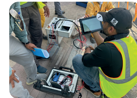
Точное обнаружение мест повреждения благодаря технологии шаговой рефлектометрии
