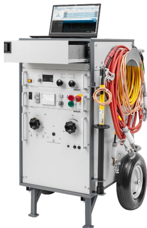
↑ Syscompact 400 portabile serve per la prelocalizzazione e la localizzazione precisa dei guasti nei cavi, è particolarmente adatto per l'uso mobile e non richiede l'installazione permanente sul veicolo.
