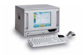
Das computerunterstützte Impulsreflexionsmessgerät IRG 3000 dient in Kombination mit der BAUR-Systemsoftware zur Kabelfehlervorortung in ein- und dreiphasigen Kabelsystemen. Im Zusammenspiel mit der leicht zu bedienenden BAUR-Systemsoftware lässt sich das IRG 3000 zu einem Komplettsystem zur Kabelprüfung und -diagnose ausbauen.
