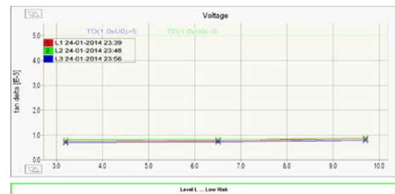
Abbildung 6 TD-Ergebnis Kabel #1, VPE-Kabel, Kabel unversehrt, TE an Muffe
