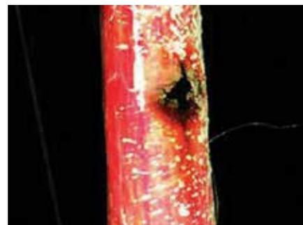
Благодаря точному определению местоположения повреждения с помощью установленного в мобильной лаборатории генератора импульсного напряжения SSG 1100 и комплекта BAUR для точной локализации (приемник звуковых частот UL30 и геомикрофон BM 30) через несколько минут удалось подтвердить правильность графической оценки, что позволило сотрудникам Advanced Vision оперативно найти и устранить дефект.
