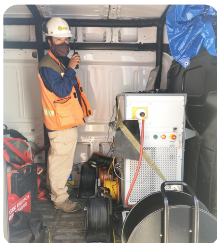
Sistema di prova VLF PHG 80 portable di BAUR
