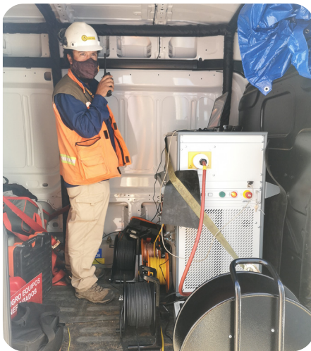
Sistema de ensayo VLF PHG 80 portable de BAUR
