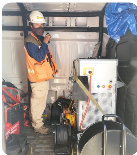
Sistema de teste VLF PHG 80 portable da BAUR
