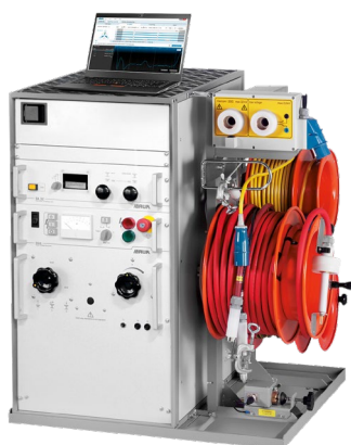
↑ Syscompact 400 可安装在厢型车或集装箱内。
